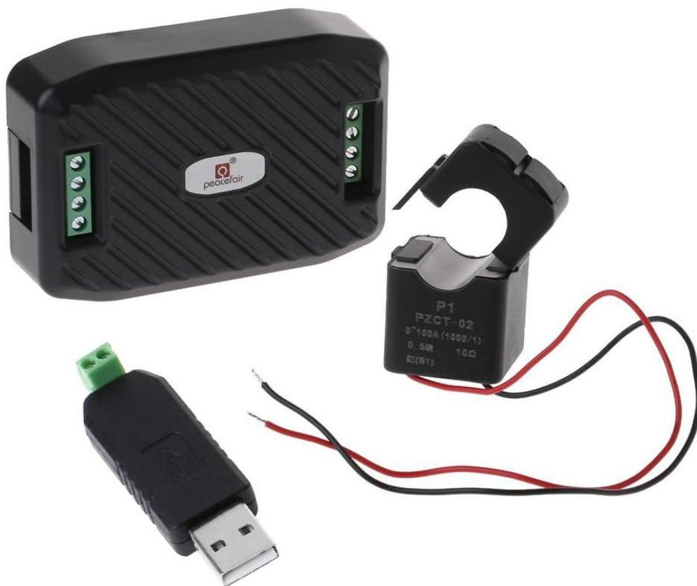
Misura della **potenza** assorbita attraverso un multimetro **PZEM-016** (~20 EUR). Nel range di potenza della nostra macchina, esegue stime con un errore dello 0,5%.
