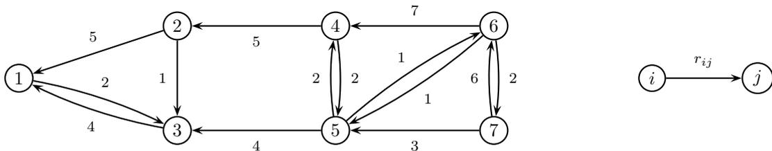
Non esistono cammini aumentanti perché il solo nodo raggiungibile da 1 con un cammino orientato è il nodo 3. Pertanto, il flusso ottenuto è massimo ed il taglio  $N_s = \{1, 3\}$ ,  $N_t = \{2, 4, 5, 6, 7\}$  è di capacità minima, infatti  $u(N_s, N_t) = u_{12} + u_{35} = 5 + 4 = 9$ .
