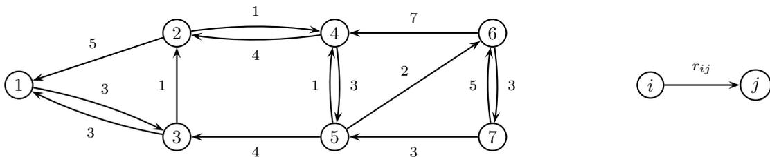
Poiché esiste il cammino aumentante  $1 - 3 - 2 - 4 - 5 - 6 - 7$  di capacità  $\delta = \min\{3, 1, 1, 3, 2, 3\} = 1$ , il flusso dato non è massimo.
