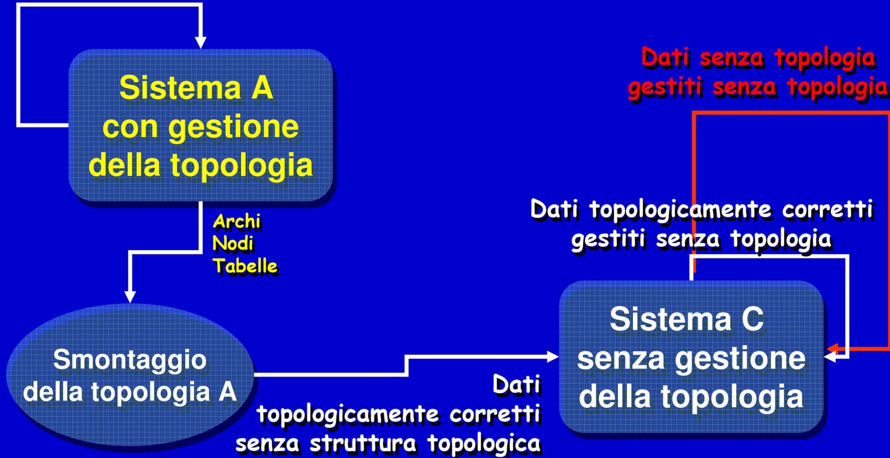
Passaggio da primitive topologiche a primitive geometriche.
