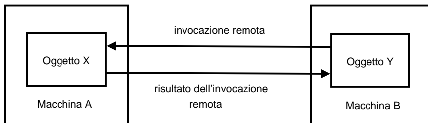
Schema Logico del Funzionamento dell'invocazione remota di metodi
