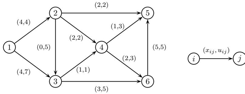
Dire se il flusso riportato in figura è massimo. Qualora non lo fosse, applicare un algoritmo per trovare un flusso massimo ed un taglio di capacità minima. Il taglio individuato è l'unico di capacità minima? Giustificare tutte le risposte.
