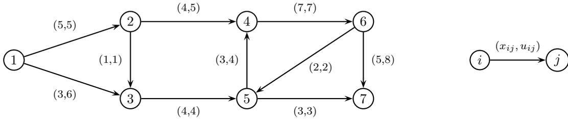
Dire se il flusso riportato in figura è massimo. Qualora non lo fosse, applicare un algoritmo per trovare un flusso massimo ed un taglio di capacità minima. Supponendo di cambiare verso a tutti gli archi del grafo, trovare un flusso massimo dal nodo 7 al nodo 1. Giustificare tutte le risposte.
