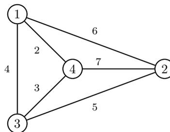
ed il seguente metodo "Branch and Bound": la soluzione ammissibile di partenza è ottenuta applicando l'algoritmo del nodo più vicino a partire dal nodo 4, la valutazione inferiore è ottenuta utilizzando il 4-albero di costo minimo come rilassamento, la ramificazione viene eseguita per costo crescente degli archi, e l'albero di enumerazione è visitato in ampiezza.
