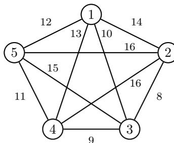
ed il seguente metodo “Branch and Bound”: la soluzione ammissibile di partenza è ottenuta applicando l’algoritmo del nodo più vicino a partire dal nodo 5, la valutazione inferiore è ottenuta utilizzando il 5-albero di costo minimo come rilassamento, la ramificazione viene eseguita per costo crescente degli archi, e l’albero di enumerazione è visitato in ampiezza.
