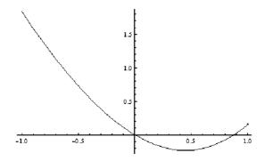
Per la convergenza ad  $\alpha$ , poiché nell'intervallo di separazione è  $f'(x) = 2x - \cos x > 0$ ,  $f''(x) = 2 - \sin x > 0$ , e inoltre f(1)f''(1) > 0, scegliendo  $x_0 = 1$  si ha convergenza monotona, del secondo ordine.
