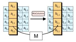
Shift Rows e Mix Columns garantiscono diffusione totale dopo solo due fasi: ogni bit di output dipende da tutti i bit di input
