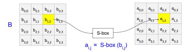
La S-box è una matrice di 16 x 16 byte, che contiene una permutazione di tutti i 256 interi a 8 bit (da 0 a 255)
