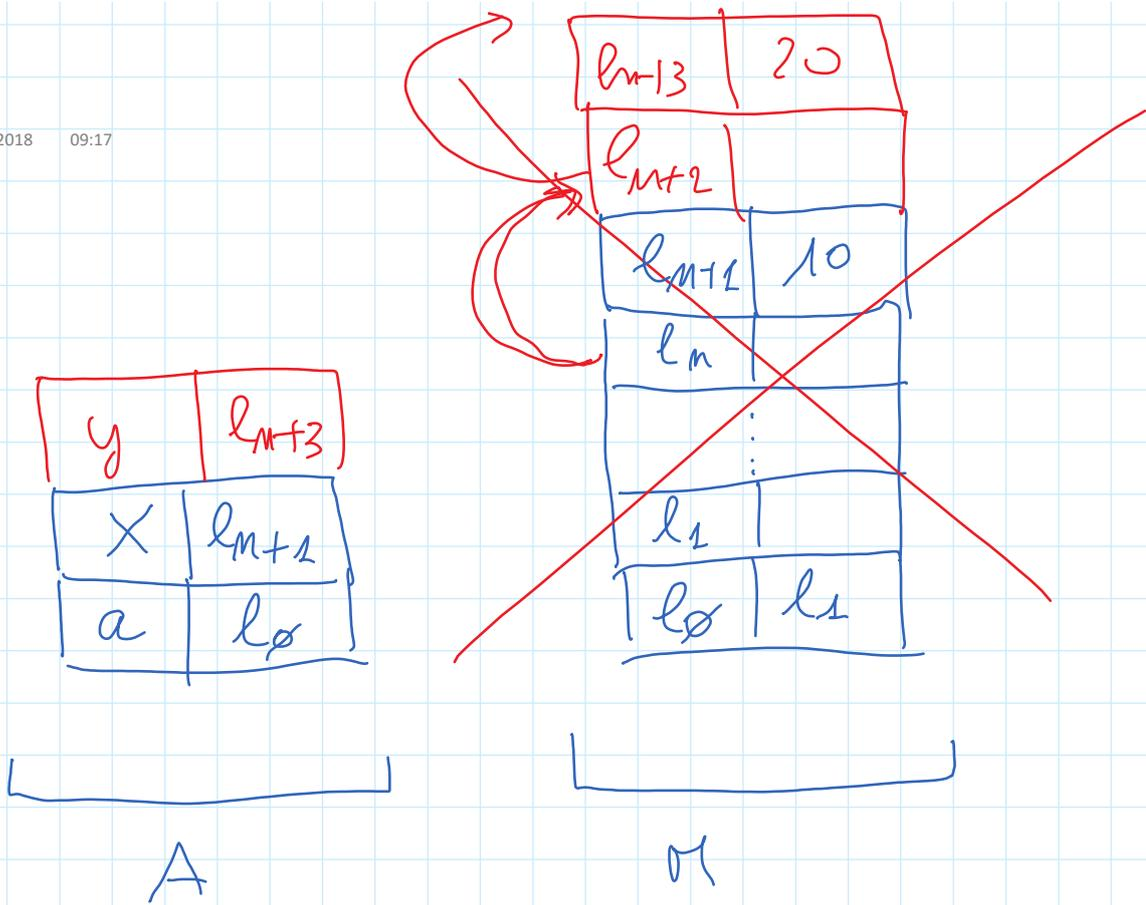
Le strutture dinamiche non possono essere (facilmente) gestite sulle memoria a pila.
